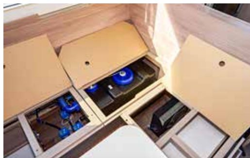
Sitztruhen belegt durch 40-L-Wassertank (Option: 70 L), drei elektrische Ablassventile, Schuhhauszug und Subwoofer.
