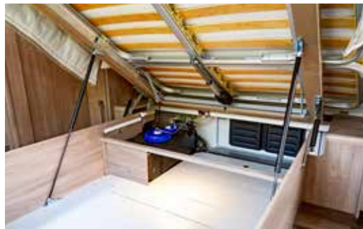
Der beleuchtete Bettstauraum mit unterlüftetem Innenboden, Abwassertank und Außenklappe.
