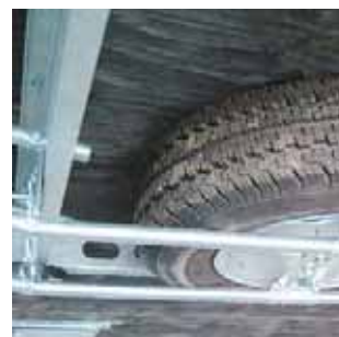
Support de roue de secours (X0063) sous le châssis.
