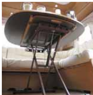
Support en ciseaux (X0003) La table avec support en ciseaux se rabat plus facilement pour transformer en lit les banquettes avant.
