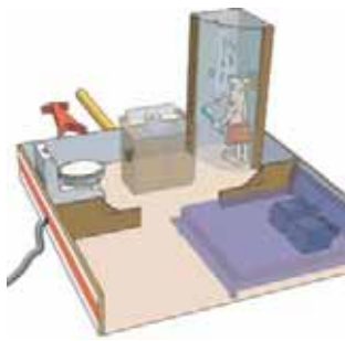
Raccordement au réseau municipal d'eau douce et d'égout. Les eaux grises de la cuisine et de la salle de bains passent à travers le réservoir des toilettes, puis sont évacuées, au moyen d'une pompe avec broyeur incorporé, vers le réseau des égouts du camping.
