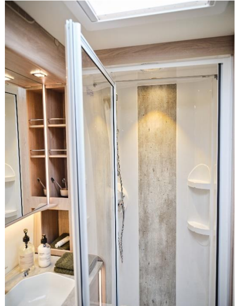
Suihkutilassa uusi betonipintaa jäljittelevä laminaatti
