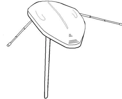
*Die Antennenstäbe lassen sich in Fahrstellung einklappen und in Empfangsstellung ausklappen.*
