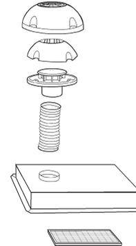
Der Abzugsfilter fängt Fett aus den Küchendünsten auf und muss hin und wieder gereinigt werden. Das Reinigungsintervall hängt von Ihren Kochgewohnheiten und der Betriebszeit des Dunstabzugs ab. Der Filter ist regelmäßig zu reinigen. Filter mit warmem Wasser und Spülmittel reinigen.
