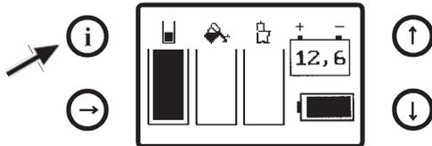
Das Display der Bedientafel ist in Betrieb, sobald der Hauptstromschalter eingeschaltet ist. Hintergrundbeleuchtung und Grundbild erscheinen.
