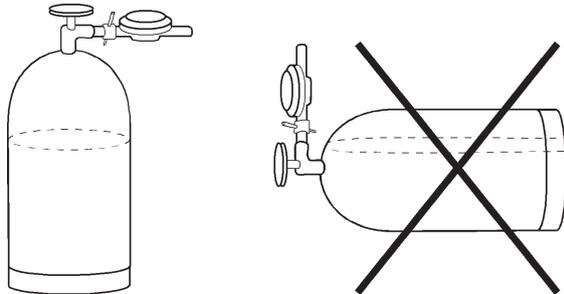
Gas kommt in zwei Formen vor: Propan und Butan. Für Wohnwagen soll Propan verwendet werden, da es bei Temperaturen von bis zu ca.  $-40^{\circ}\text{C}$  vergast, während Butan bei  $\pm 0^{\circ}\text{C}$  aufhört zu vergasen.
