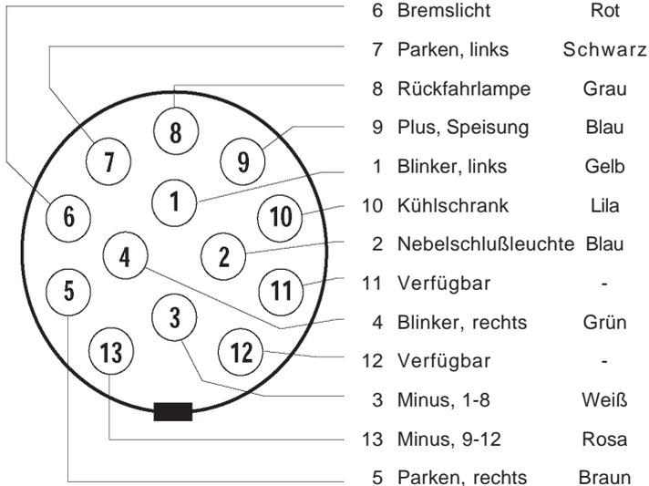
Falls Ihr Fahrzeug eine 7-polige Steckdose hat, können Sie ein Adapter benutzen. Der Adapter ist nur ein einfacher Adapter, der Ihnen ermöglicht, Ihren Wohnwagen zu transportieren. Bei angeschlossenem Adapter sind jedoch folgende Funktionen außer Betrieb gesetzt:
