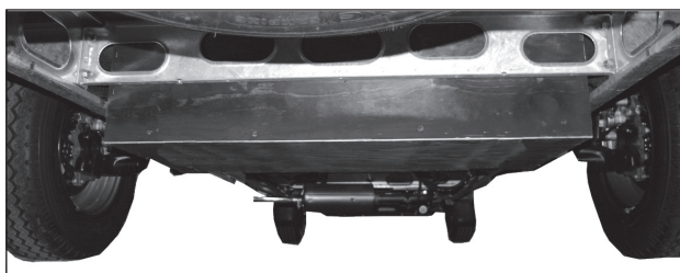
Gråvannstanken er montert ved bobilens bakaksel.
