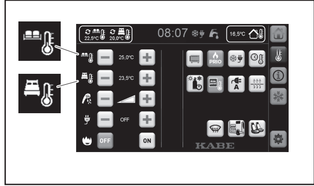
Vyöhykelämmitys: erilaiset lämpötilat istuinryhmässä ja makuuosassa.
