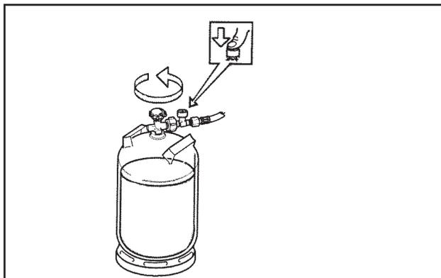
Knopf drücken, sodass das Schlauchbruchventil öffnet.
