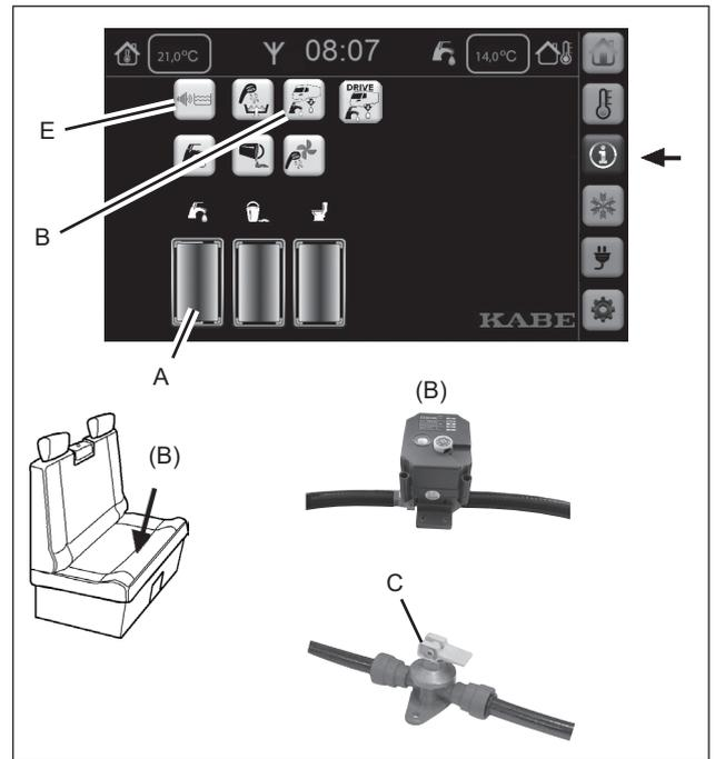
1 Alarm (E) an der Bedientafel aktivieren.
