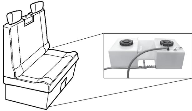
Zur Wahl des Transportmodus auf das entsprechende Symbol an der Bedientafel drücken. Daraufhin läuft unter dem Wohnmobil Wasser aus, bis der Frischwassertank noch ca. 20 Liter enthält.
