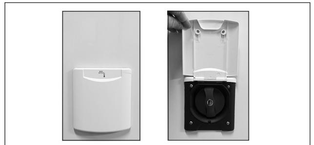
Bei manchen Wohnmobilen lässt sich der Deckel des Frishwassertanks auch öffnen. Das ermöglicht die Reinigung des Tankinnern mit Spülmittel und Spülbürste.
