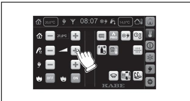
Die Warmwasser-Temperatur im Heizkessel lässt sich vorübergehend erhöhen. Damit steht eine größere Wassermenge mit der gewünschten Temperatur zur Verfügung.
