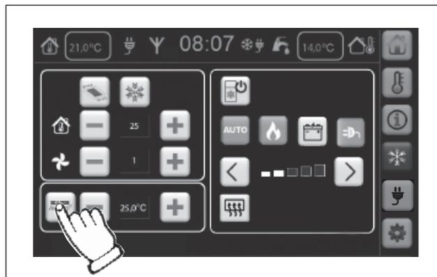
Das Gebläse kann auf mehrere Drehzahlen in beiden Laufrichtungen eingestellt werden.
