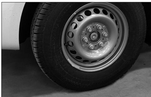
Es ist wichtig, dass die für die jeweilige Felge passenden Radschrauben verwendet werden. Die Anlageflächen der Schrauben können sich je nach Felgentyp unterscheiden. Wird eine Felge mit den verkehrten Radschrauben festgeschraubt, kann das zu Schäden führen.
