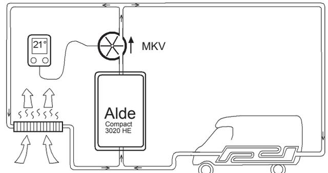
Abb. 1: Schematische Darstellung des Heizsystems im Wohnteil.
