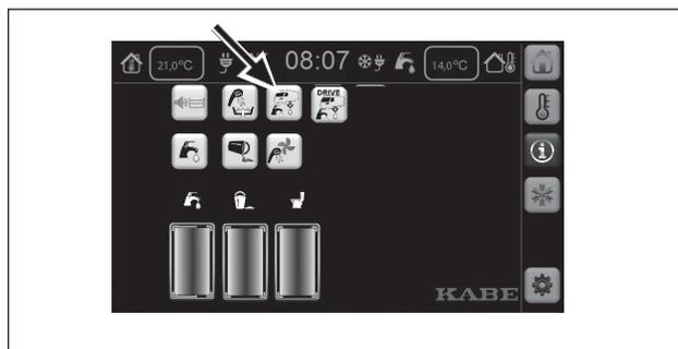
Zur Vollständigen Entleerung des Systems alle Wasserhähne im Wohnmobil öffnen, sodass bei Auslaufen des Wassers Luft in die Leitungen nachströmen kann (sowohl Kalt- als auch Warmwasserleitungen).
