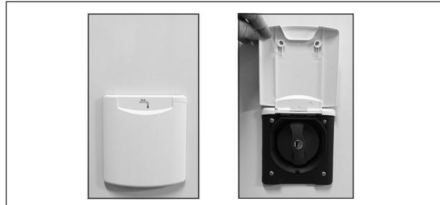
Bei manchen Wohnmobilen lässt sich der Deckel des Frischwassertanks auch öffnen. Das ermöglicht die Reinigung des Tankinnern mit Spülmittel und Spülbürste.
