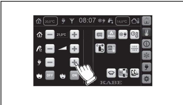
2 Leistungsstufe für den Elektrobetrieb wählen:
