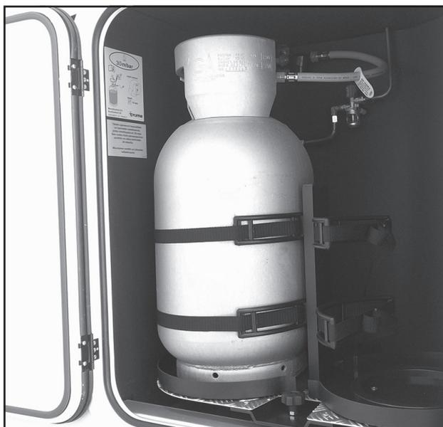
Gasflasche im Gaskasten.
