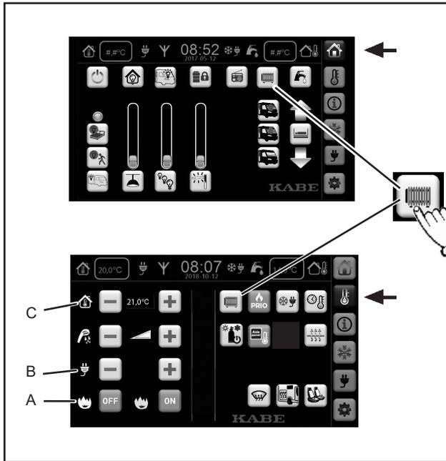
Zum Einschalten des ausgeschalteten Heizungssystems auf das Symbol „Heizung EIN-AUS“ drücken.
