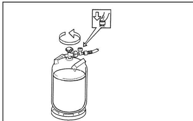
Knopf drücken, sodass das Schlauchbruchventil öffnet.
