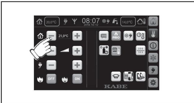
Zur Warmwasserproduktion muss das Heizungssystem eingeschaltet sein (Gas- oder Elektrobetrieb).
