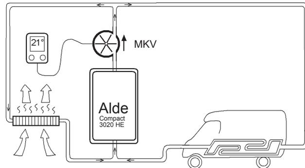
Abb. 1: Schematische Darstellung des Heizsystems im Wohnteil.
