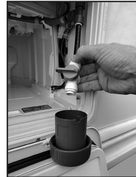
Ventil schließen, nachdem alles Wasser ausgelaufen ist, um zu verhindern, dass beim nächsten Befüllen des Wassersystems Wasser ausläuft.
