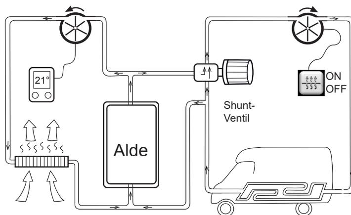
Luft wird in den Konvektoren erwärmt und steigt entlang der Wände nach oben.
