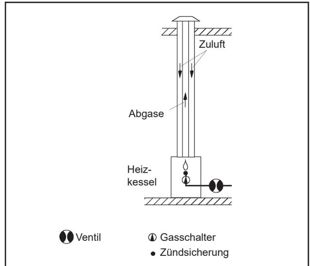
Der Gasbetrieb des Heizkessels wird bei Anlassen des Motors ausgeschaltet.
