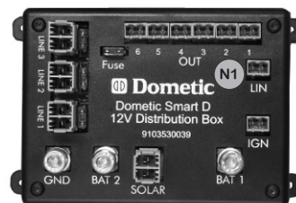
Einheit N1 des Elektrosystems. Dometic Smart D 12V Distribution Box.
