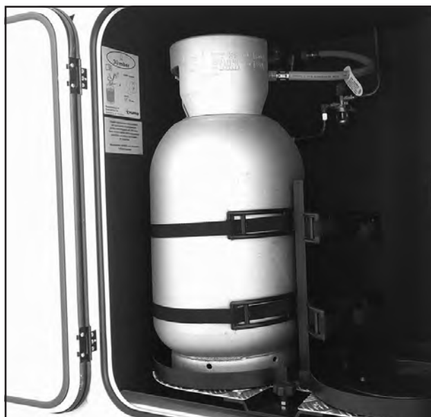
Gassflasken i gasskassen.
