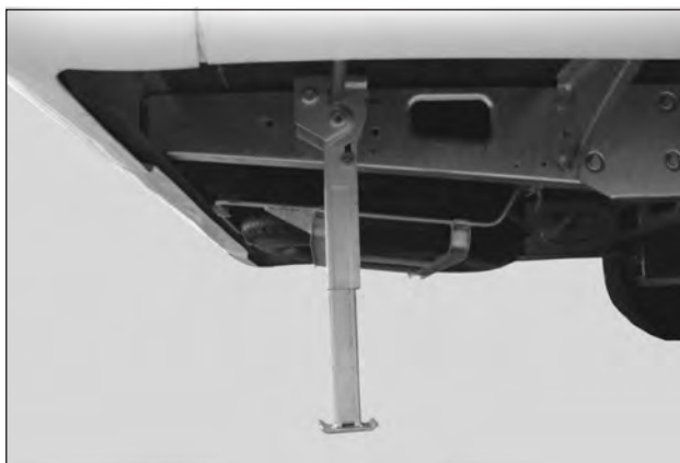
Støtteben sveivet ned for å stabilisere bobilen.
