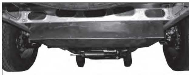
Gråvannstanken er montert ved bobilens bakaksel.
