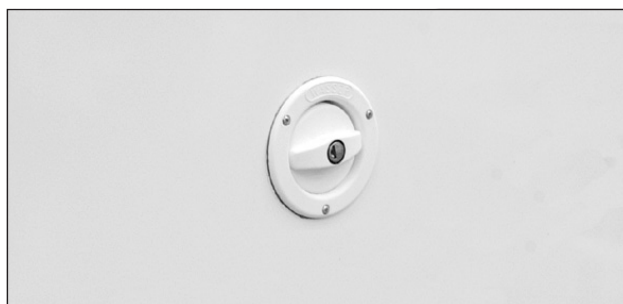
Påfylling av ferskvann.
