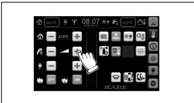
Die Wassertemperatur lässt sich vorübergehend von 55 auf 65 °C erhöhen. Auf diese Weise lässt sich eine größere Menge Wasser mit der gewünschten Temperatur zapfen.
