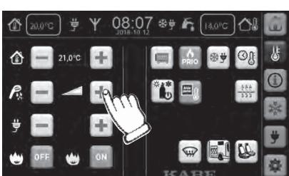
Temperaturen på varmtvannet kan økes midlertidig fra 50 til 65 °C. Dermed kan man få en større mengde vann med ønsket temperatur.
