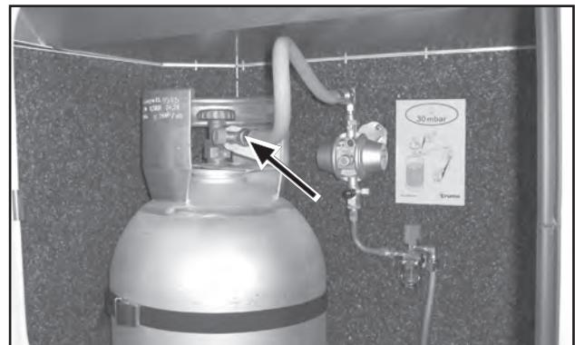
Trykk på knappen slik at slangebruddsventilen åpnes. Hvis slangebruddsventilen er stengt, kan gassapparatene ikke tennes.
