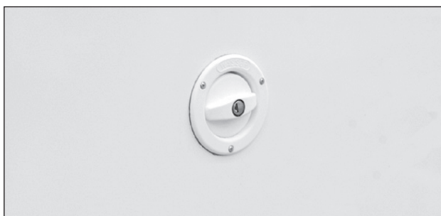
Nachfüllstutzen für Frischwasser.
