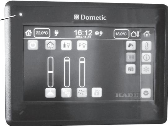
Am Rahmen der Bedientafel befindet sich eine Indikationsleuchte.
