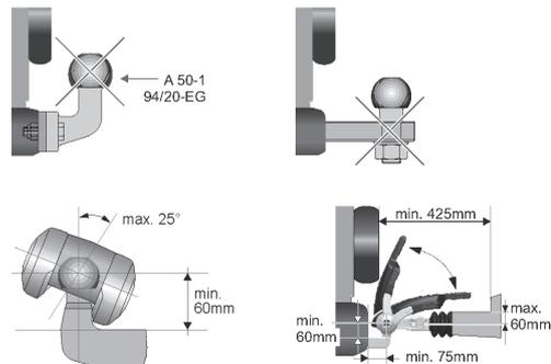
Zum Rangieren des Wagens nicht den Handgriff der Kugelkupplung verwenden. Dadurch könnten innere Teile beschädigt werden.
