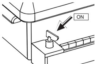
*Der Sicherheitsschalter muss eingeschaltet sein, damit elektrische Anlage und Bedientafel funktionieren.*
