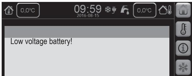
Wenn das Ladeniveau der Batterie weiter abfällt, schaltet das Elektrosystem einen Großteil der an die elektrische Anlage angeschlossenen Verbraucher ab. Mehrere elektrische Funktionen fallen dann aus, wie z.B. Lampen und Pumpen. Auch Kühlschrank und Heizkessel fallen aus, da die Stromversorgung der Elektronik unterbrochen wird. Eine Warnmeldung erscheint und ein Alarmton ist zu hören.
