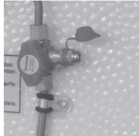
Der Gasdruck des äußeren Anschlusses wird durch das Druckminderventil geregelt und entspricht dem Druck der übrigen Gasanschlüsse im Wohnwagen.
