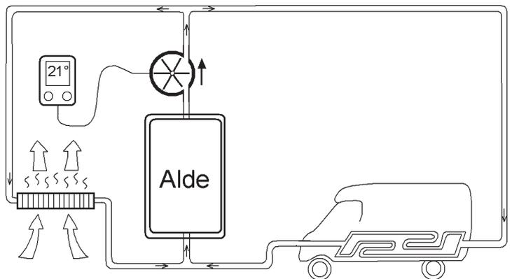
Luft wird in den Konvektoren erwärmt und steigt entlang der Wände nach oben.
