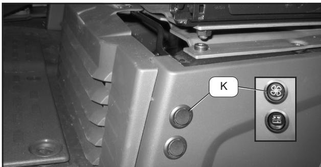
1 Schalter F am Armaturenbrett des Fahrzeugs drücken. Dadurch öffnet ein Magnetventil und lässt warme Kühlflüssigkeit des Motors durch Heizgerät und Wärmetauscher zirkulieren.
