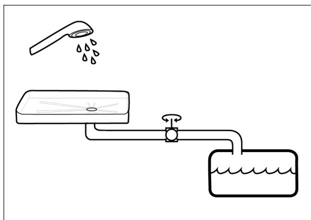
Ventil zum Schließen des Duschabflusses.
