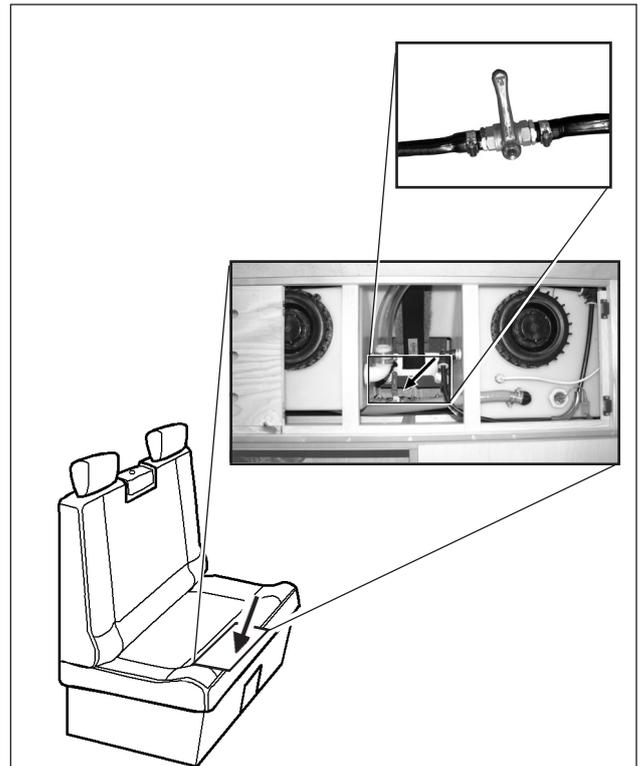
Der Frischwasser-Ablasshahn des Wassersystems.
