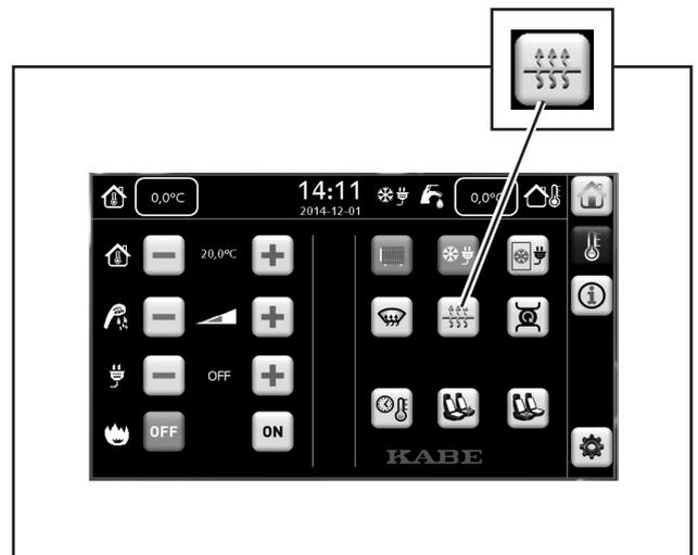
Die Fußbodenheizung hält unabhängig von der Innentemperatur des Wohnwagens eine gleichmäßige Temperatur.
