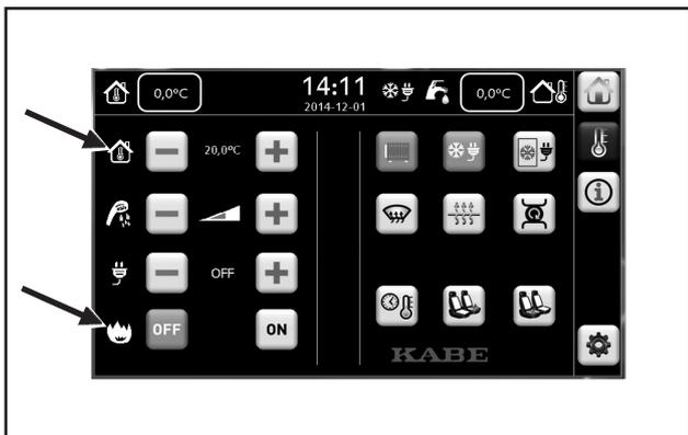
3 Zum Einschalten der Umwälzpumpe im Wohnteil, das Heizungssystem an der Bedientafel des Heizkessels einschalten.
