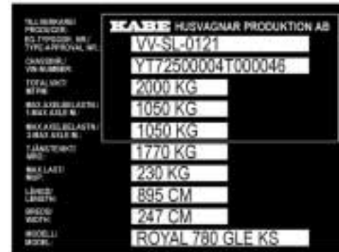
Yhdistetty tyypikilpi ja katsastuskilpi Ruotsin markkinoita varten.
