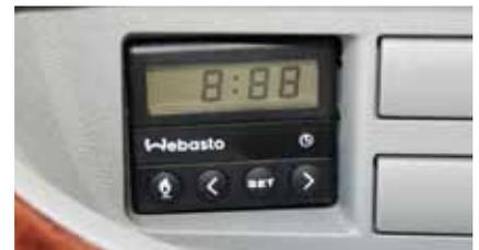
Alle KABE-Wohnmobile sind serienmäßig mit einer Webasto-Zeitsteuerung ausgerüstet. Mit der Webasto-Zeitschaltuhr lässt sich das Fahrerhaus bei abgestelltem Motor bis zu 24 Stunden vor Abfahrt beheizen.
