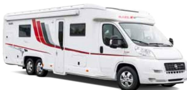
Der 880 wird auf ein maßgeschneidertes AL-KO-Fahrwerk gebaut. Die Tandemachse hinten und der lange Achsstand verleihen dem Fahrzeug hohe Fahrstabilität und minimieren die Seitenwindanfälligkeit. Die Tandemachse sorgt bei langen Fahrzeugen mit längerem Überstand und höherem Gewicht für eine beruhigte
