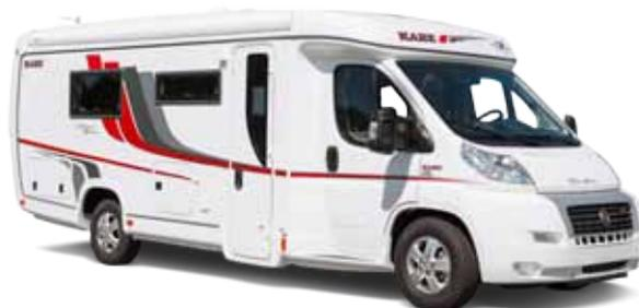
Der KABE Travel Master 750 wird auf dem bewährten Fiat Ducato mit einem für KABE maßgeschneiderten, galvanisiertem AL-KO-Fahrwerk gebaut. Dieses tief gebaute Fahrwerk bietet zusammen mit dem 180 PS starken 3-Liter-Motor und dem 6-Gang-Getriebe eine hervorragende Fahrdynamik. Der tiefe Schwerpunkt, die größere Spurbreite hinten und die
