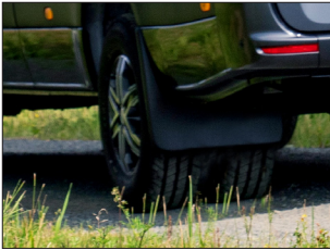
Tvillingehjul 4 x 2 och 4 x 4: 5 tons, ca. 850 kg ekstra lastvægt, bruttovægt 7 tons
