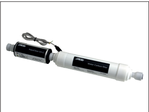
"Vandfilter rensning" - ALDE AquaClear UV-C (til fyrret ALDE Compact 3030). Effektiv vandrensning, der beskytter brugerens helbred på en skånsom og miljøvenlig måde. Systemet fjerner uønskede vira og bakterier, pesticider og kemikalier. Vandet desinficeres med UVC-lys genereret af lysdioder. Derefter løber vandet også gennem kulfiltre, der giver lugtfrit vand uden dårlig smag eller farve.
