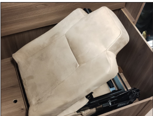
Opdateret 5. selesæde med fremadvendt stol! Hele sikkerhedsselepladsen kan nemt afmonteres og fjernes for at spare på vægten.
