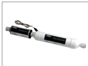
"Vannrensing" – Alde AquaClear UV-C (til sentralvarmeren Alde Compact 3030). Effektiv vannrensing som beskytter brukerens helse på en skånsom og miljøvennlig måte. Fjerner uønskede virus og bakterier, planterevmidler og kjemikalier. Vannet desinfiseres med UVC-lys generert av lysdioder. Deretter går vannet gjennom et kullfilter som gir et luktfritt vann uten dårlig smak eller farge.
