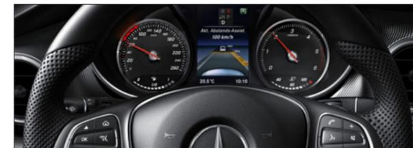
**DISTRONIC / Adaptive Geschwindigkeitsregelung:** Einfach den gewünschten Abstand im Assistenten einstellen und der aktive Abstandsassistent DISTRONIC hält den vom Fahrer eingestellten Abstand zum vorausfahrenden Fahrzeug konstant ein. Somit wird der Fahrer z.B. bei Autobahnfahrten oder im Stop-and-Go-Verkehr entlastet. Die DISTRONIC ist beim Imperial serienmäßig, beim Royal und Crown ist sie als Zubehör erhältlich.
