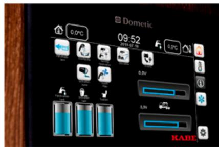
Aktuelle Statusinformationen wie Frisch- und Abwasserpegel sowie die Batteriespannung werden übersichtlich angezeigt.
