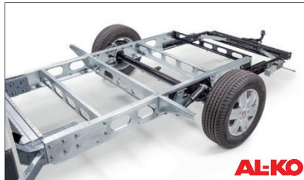
Die Royal, Crown- und Imperial-Modelle von KABE werden auf der neuen starken Kombination von Mercedes-Benz + AL-KO gebaut. Dazu kommen die Federung und die Stoßdämpfung, die AL-KO in Zusammenarbeit mit Mercedes-Benz noch weiter verfeinert hat.
