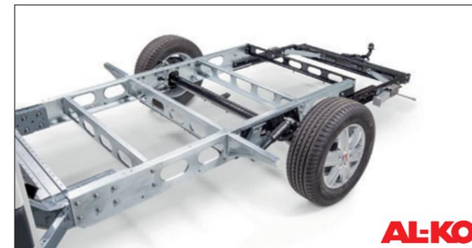
Die Classic i740-Modelle von KABE werden auf galvanisierten AL-KO Fahrwerken gebaut, die individuell dem jeweiligen Modell angepasst sind. Kennzeichnend für KABE-Wohnmobile ist der lange Radstand und der geringe Hecküberstand. Das bedeutet gute Lastverteilung, was in Kombination mit der individuellen Federung der Hinterachse hohen Fahrkomfort und eine stabile Straßenlage gewährleistet.
