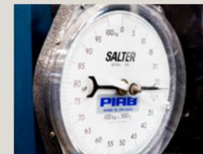
**ANHÄNGERKUPPLUNG.** Zugprüfinstrument für Wohnmobile.
