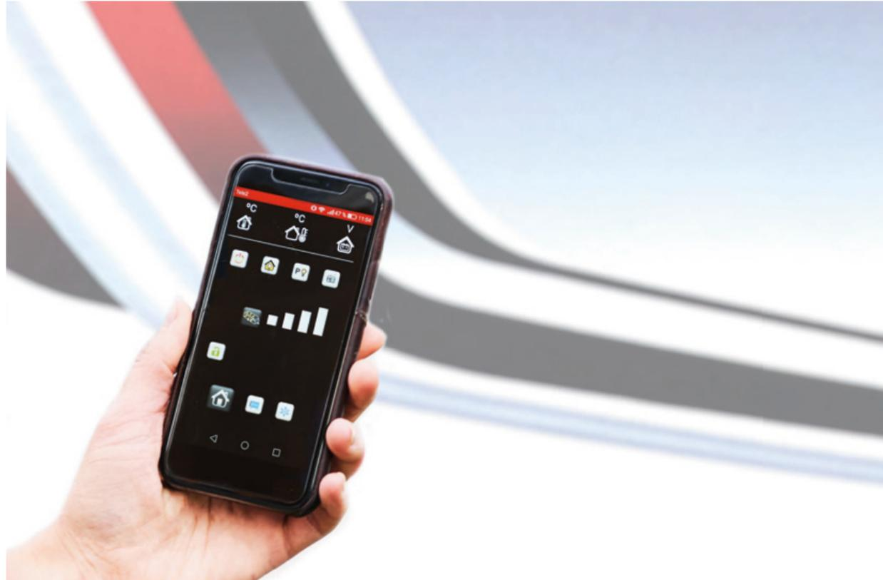
**KABE Smart D Remote.** KABE Smart D Remote\* ermöglicht die Fernsteuerung der Bedientafel im Wohnmobil von einem beliebigen Ort mit Hilfe einer Smart-phone-App. Das System basiert auf einem 4G-Router mit externen Antennen und einem mobilen Modem. Damit können Sie nicht nur die Heizung und die Beleuchtung steuern sowie Funktionen und Alarmmeldungen des Wohnmobils über das Handy kontrollieren, sondern Sie haben unterwegs auch Zugriff auf eine gute, drahtlose Internetverbindung.
