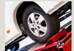
**HALTBARKEIT IM FAHRTTEST.** Der Belastungstest wird auf einem Rüttelstand durchgeführt und entspricht einer normalen Fahrleistung von 100.000 km.
