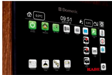
Auf der Startseite werden alle Schalter für die Beleuchtung sowie der digitale Schieberegler für die Dimmerfunktion angezeigt. Hier können Sie auch Außen- und Innentemperatur sowie die Uhrzeit ablesen.
