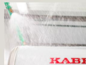
**REGENKAMMER.** In der Regenkammer werden die Wohnmobile unter hohem Druck besprüht.
