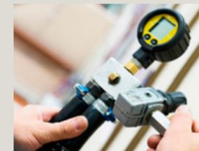
**GASSYSTEM.** Das Gassystem wird Drucktests unterzogen.
