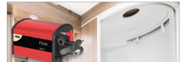
**Alde Flow.** Mit Alde Flow können Sie so lange warm duschen, wie es Ihnen gefällt. Alde Flow ist ein separater Warmwassertank, den Sie an die Glykol-Heizungsanlage anschließen. Im Tank wird das Frischwasser vorenwärmt, bevor es in den Warmwassertank des Heizkessels fließt. So ist die konstante Warmwasserversorgung gewährleistet.
