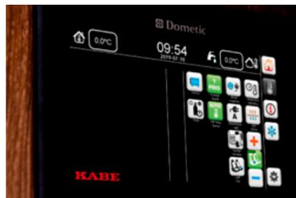
Meldungen und Steuermöglichkeiten für das Heizungssystem werden auf einer eigenen Seite angezeigt. Hier können Sie mit dem digitalen Schieberegler ganz einfach die Temperatur erhöhen oder senken.
