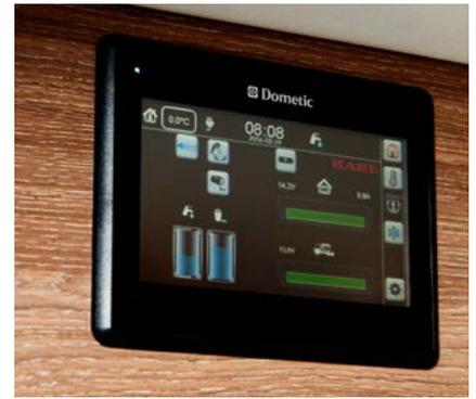
Aktuelle Statusinformationen zu Frisch- und Grauwasserstand sowie die Batterie-Spannung werden übersichtlich angezeigt.
