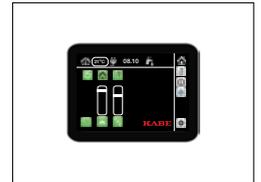
**KABE Smart D – intelligente Stromzentrale.** Bedienerfreundliche Schalttafel. Das elektrische System fühlt den Ladezustand der Batterie ab und lädt diese im Bedarfsfall automatisch auf. Das System überwacht auch Wasserstand, Temperatur und Batteriespannung.
