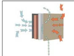
**Belüftete Wände und Böden.** KABE hat als einziger Wohnmobilbauer eine lüftungsaktive Tapete, die warme, entlang der Wände zirkulierende Luft, durchlässt. Kondenswasser wird am Boden von einer belüfteten, entlang den Kanten verlegten Matte aufgefangen und verdunstet, wenn die Heizung eingeschaltet wird. Die Wandtapete von KABE hat auch eine schalldämmende Wirkung.
