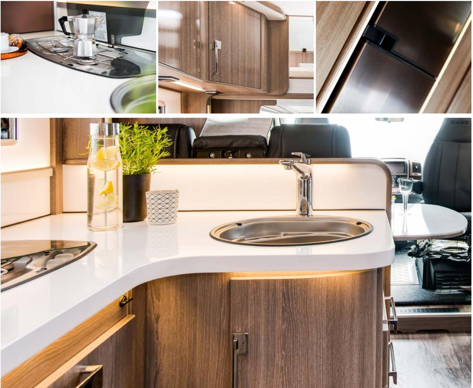
Der vollautomatische Kühlschrank mit AES schaltet je nach verfügbarer Energiequelle selbständig zwischen 230-V-, 12-V- und Gasbetrieb um. Der 3-flammige Herd hat eine geteilte Abdeckung, was eine wertvolle zusätzliche Abstellfläche bietet.
