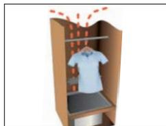
**Trockenschrank.** Trockenschrank mit selbst entworfenener Tropfschale zum Trocknen der Schuhe. Der Trockenschrank hat einen speziellen Konvektor und ein regelbares Dachventil für die optimale Warmluftzirkulation.
