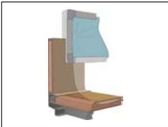
**iWall für eine robuste und feuchtesichere Karosserie.** Die Karosserie wird nach dem Sandwich-Prinzip gebaut: Glasfasern, 36 mm Ecoprim-Isolierung, Innenblech und eine Wandtapete, die eventuelles Kondenswasser aufsaugt. Mit der neuen iWall-Konstruktion wird die Karosserie extrem stabil und absolut feuchtesicher. Aluminiumbleche auf beiden Seiten der Ecoprim-Isolierung minimieren die Auswirkungen von Temperaturschwankungen.
