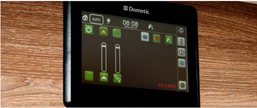
Auf der Startseite werden alle Knöpfe für die Beleuchtung sowie der digitale Schieberegler für die Dimmerfunktion angezeigt. Hier können Sie auch Außen- und Innentemperatur sowie die Uhrzeit ablesen.
