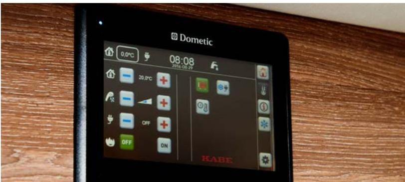
Meldungen und Steuermöglichkeiten für das Heizungssystem werden auf einer eigenen Seite angezeigt. Hier können Sie mit dem digitalen Schieberegler leicht die Temperatur erhöhen oder senken.
