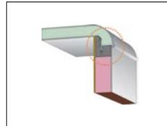
**Dichte Dachfugen.** Das Dach wird über die Seitenwände gebogen. Das garantiert völlige Dichtheit. Die einzigartige iWall-Konstruktion von KABE bietet unzählige Befestigungspunkte, was bei der Montage von Sonderzubehör sehr wichtig ist. Die KABE-Isolierung in Wänden und Fenstern hält den Wohnmobil im Winter warm und im Sommer kühl.
