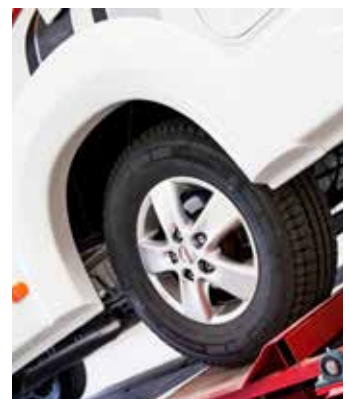
Holdbarhetstest simuleres i en vibrasjonsbenk og tilsvarer 10 000 mil normal kjøring.
