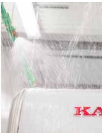
In der Regenkammer werden die Wohnmobile unter hohem Druck besprüht.
