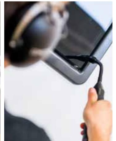
Mit neuester Technik kontrollieren wir, dass die Wohnmobile absolut dicht sind.
