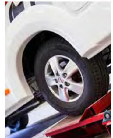
Der Beständigkeitstest wird auf einem Rüttelstand durchgeführt und entspricht einer normalen Fahrleistung von 100.000 km.
