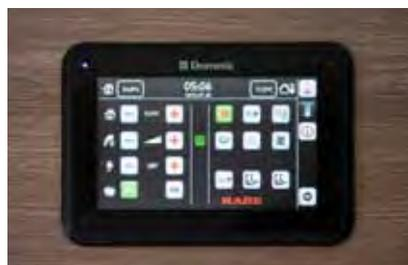
Meldungen und Steuermöglichkeiten für das Heizungssystem werden auf einer eigenen Seite angezeigt. Über einen digitalen Schieberegler lässt sich die Temperatur erhöhen bzw. senken.
