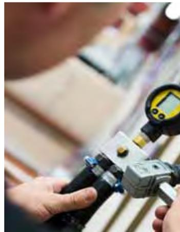
Das Gassystem wird Drucktests unterzogen.
