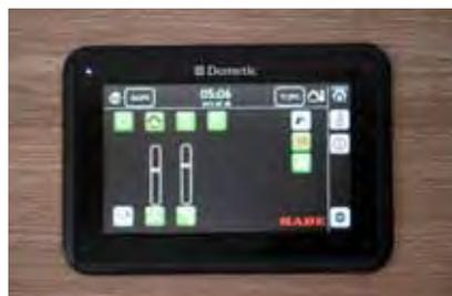
Auf der Startseite werden alle Knöpfe für die Beleuchtung sowie der Schieberegler für die Dimmerfunktion angezeigt. Auch die Außen- und Innentemperatur sowie die Uhrzeit lassen sich hier ablesen.
