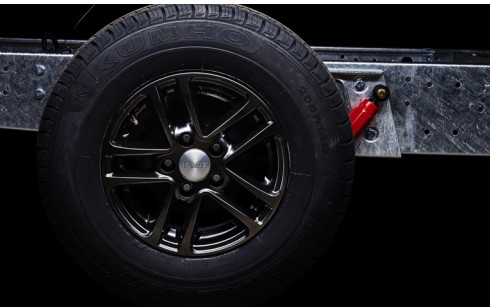
Däcken och kopplingen. Däck på enkelaxlade vagnar är av typ premiumdäck. 14" plåtfälg är standard på Estate och 15" alufälg finns som tillval i designpaketet. Ädelsten och Royal har 15" alufälg som standard och Imperial 17" Diamond Cut alufälg (tillval Royal). Alla vagnar har friktionskoppling.
