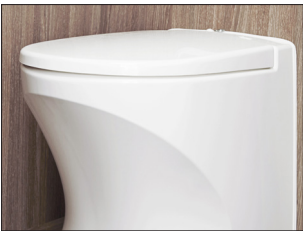
Cinderella förbränningstoilet. Cinderella är en modern och miljövänlig toalettlösning med stor kapacitet och hög driftsäkerhet. Under hög temperatur förbränns papper, urin och fekalier till en minimal mängd aska, ca en kopp per person och månad. Rent, hygieniskt och luktfritt (alla TDL-modeller och 780 DGLE).
