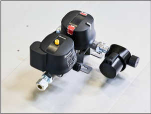
Duo Control. Duo Control har indbygget, automatisk gasomkobler, reduktionsventil og kollisionsensor, som udløses ved sammenstød med en G-kraft på 3,5 G. Flaskegas-tilførslen lukkes derefter straks af for at undgå gaslækage. Duo Control er godkendt i hele Europa til at være tilsluttet under kørslen.
