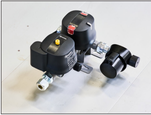
Duo Control har indbygget, automatisk gasomkobler, reduktionsventil og kollisionssensor, som udløses ved sammenstød med en G-kraft på 3,5 G. Flaskegas-tilførslen lukkes derefter straks af for at undgå gaslækage. Duo Control er godkendt i hele Europa til at være tilsluttet under kørslen.
