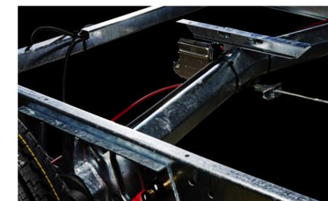
**Besonders verdrehsteifes Fahrwerk.** Zusätzliche Traversen zwischen den Längsträgern des Fahrwerks verstärken den Fußboden und erhöhen die Verdrehsteifigkeit des Chassis. Die Chassis haben Ausleger von den Längsträgern zur Entlastung der Spannungen zwischen Fußboden und Wand. Die Karosserie ist für sehr hohe Belastungen ausgelegt, beispielsweise für große Schneelasten auf dem Dach.
