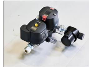
Duo Control hat einen eingebauten, automatischen Gasschalter, ein Reduktionsventil und einen Aufprallsensor, der bei einem Aufprall mit einer G-Kraft von 3,5 G auslöst und die Gasversorgung unterbricht, um das Ausströmen von Gas zu verhindern. Duo Control ist in ganz Europa zugelassen und erlaubt den Gasbetrieb während der Fahrt.
