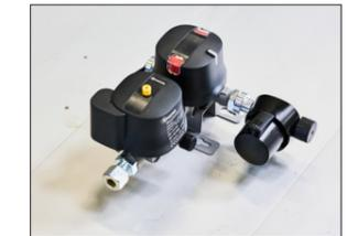
**Duo Control.** Duo Control hat einen eingebauten, automatischen Gasschalter, ein Reduktionsventil und einen Aufprallsensor, der bei einem Aufprall mit einer G-Kraft von 3,5 G auslöst und die Gasversorgung unterbricht, um das Ausströmen von Gas zu verhindern. Duo Control ist in ganz Europa zugelassen und erlaubt den Gasbetrieb während der Fahrt.
