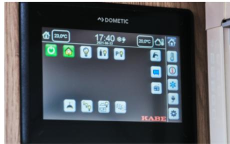
Auf der Startseite werden alle Schalter für die Beleuchtung sowie die digitalen Schieberegler für die Dimmerfunktionen angezeigt. Hier können auch Außen- und Innentemperatur sowie die Uhrzeit abgelesen werden.
