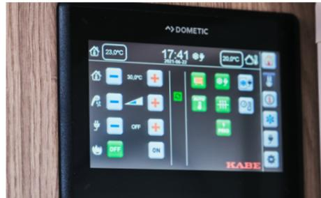
Meldungen und Steuermöglichkeiten für das Heizungssystem werden auf einer eigenen Seite angezeigt. Hier können Sie mit den +/- Tasten leicht die Temperatur erhöhen oder senken.
