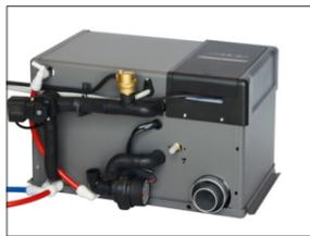
ALDE Flow für den Heizkessel Alde 3030 Plus. Mit Alde Flow können Sie so lange warm duschen, wie es Ihnen gefällt. Der Warmwassertank der Alde Flow ist in den neuen Heizkessel Alde 3030 Plus integriert. In der Heizung wird das Frischwasser vorerwärmt, bevor es in den Warmwassertank des Heizkessels fließt. So ist die konstante Warmwasserversorgung gewährleistet.
