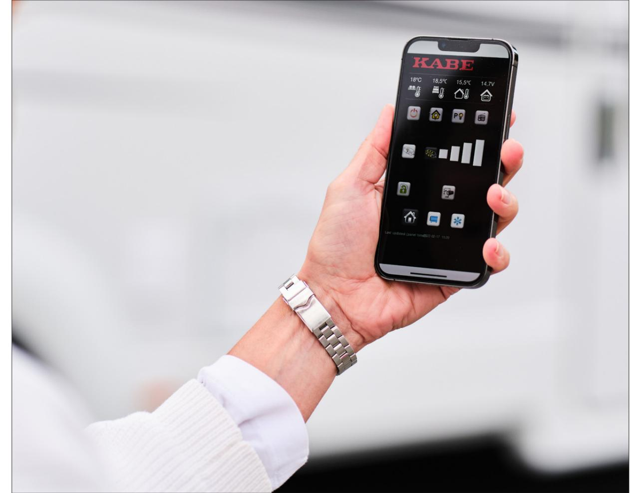
**KABE Smart D Remote.** Mit KABE Smart D Remote\* können Sie das Bedienpanel Ihres Wohnwagens von jedem beliebigem Ort aus über eine App steuern. KABE Smart D Remote basiert auf einem 4G-Router mit internen Antennen (externe Antenne als Zubehör erhältlich). Damit können Sie nicht nur die Heizung und die Beleuchtung steuern, sondern auch weitere Funktionen und Alarmmeldungen des Wohnwagens über das Handy kontrollieren.
