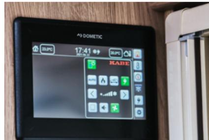
Mit Smart D können Sie Kühlschrank, Klimaanlage, Air-Vent und weitere Funktionen zentral von dem übersichtlichen Display steuern.
