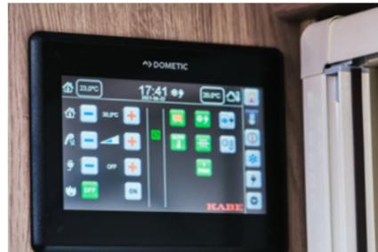
Meldungen und Steuermöglichkeiten für das Heizungssystem werden auf einer eigenen Seite angezeigt. Hier können Sie mit den +/- Tasten leicht die Temperatur erhöhen oder senken.
