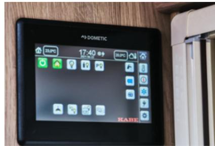
Auf der Startseite werden alle Schalter für die Beleuchtung sowie der digitale Schieberegler für die Dimmerfunktion angezeigt. Hier können auch Außen- und Innentemperatur sowie die Uhrzeit abgelesen werden.
