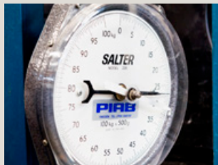
TREKINRICHTING. Meetinstrument voor de trekrichting.
