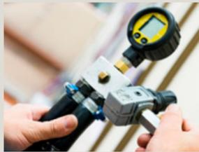
**GAZ.** Le circuit de gaz est testé sous pression.
