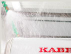
**CABINE DE TEST D'ÉTANCHÉITÉ À LA PLUIE.** Les caravanes sont aspergées d'eau sous haute pression.
