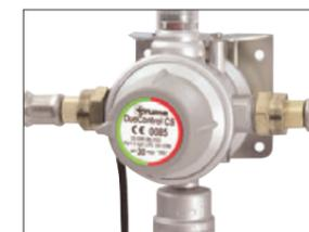
**Duocontrol.** Équipements intégrés : commutateur de gaz automatique, soupape de réduction et capteur de collision se déclenchant en cas de choc avec force G de 3,5 G. L'alimentation en gaz est alors coupée immédiatement pour éviter toute fuite. Le système Duo Control est homologué dans l'Europe entière pour que le circuit de gaz soit enclenché pendant le déplacement.
