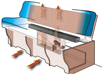
**Circulation de l'air parfaite.** Nos éléments d'aménagement intérieur sont adaptés pour fournir une circulation optimale de l'air dans toute la caravane, y compris derrière les placards et les banquettes. La distance entre les banquettes et les lits, et l'angle du dossier de banquettes, est soigneusement calculée.
