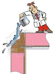
**Raccords de toit étanches.** Le raccord entre le toit et les cloisons est tout d'abord étanchéifié minutieusement à l'aide d'une pâte élastique au butyle. La phase suivante consiste à plier la tôle de toit pour la rabattre sur la tôle de la cloison – avec recouvrement bien entendu – pour supprimer entièrement les possibilités de fuites. Le concept unique iWall de KABE permet de prévoir un nombre de points de fixation illimité, ce qui est important pour installer des équipements optionnels.
