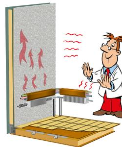
**Tôle intérieure dans les cloisons.** La construction sandwich de KABE se compose d'une tôle extérieure, d'un isolant Ecoprim, d'une tôle intérieure et d'un papier mural. La chaleur des radiateurs se diffuse le long des cloisons. La tôle intérieure dans les cloisons distribue la chaleur dans toute la cloison, contrairement au contreplaqué qui ne diffuse aucune chaleur. Le chauffage par le sol est assuré par des plaques chauffantes disposées dans le sol.
