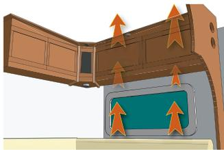
**Libre passage de l'air.** Dans les éléments supérieurs, des canalisations d'air incorporées permettent à l'air chaud de passer librement au niveau du raccord entre le toit et les cloisons, pour rejoindre ensuite le centre de la caravane. Une cloison intermédiaire au dos des éléments de rangement permet de ne jamais obturer ces canalisations d'air, même quand les éléments sont pleins.
