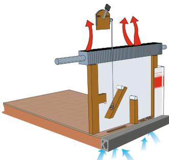
**Système de ventilation optimisé – brevet KABE VarioVent.** Le système de ventilation breveté permet de réguler la quantité d'air frais suivant les besoins. Le système est doté d'une ouverture de ventilation qui se règle au moyen d'une manette.
