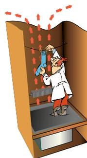
**Armoire de séchage.** Récipient d'égouttage de conception propre pour le séchage des chaussures. L'armoire de séchage a un convecteur spécial et une bouche de ventilation de toit pour optimiser la circulation de la chaleur. Casier à chaussures chauffé derrière la porte. Placard à l'entrée pour ranger les vêtements extérieurs.
