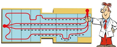
**Meilleur confort de chauffage.** Le système automatique breveté de chauffage par le sol à circulation d'eau, AGS II, avec quatre circuits, donne une répartition de chaleur encore plus homogène. Les boucles chauffantes, insérées dans des tubes en aluminium, vont jusqu'à la porte d'entrée, le plan de travail et le cabinet de toilette. Les plaques chauffantes répartissent uniformément la chaleur sur toute la surface du sol.
