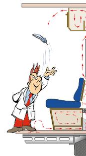
**Répartition de la chaleur bien conçue et homogène.** Les caravanes KABE sont construites pour assurer la meilleure diffusion de la chaleur possible. Le système conçu par KABE permet à l'air de circuler librement depuis le sol, sous les lits et les banquettes, à travers les éléments de rangement supérieurs ventilés, pour remonter ensuite vers le plafond. KABE a la meilleure répartition de la chaleur, et la plus homogène, dans la partie habitable ainsi que dans les autres espaces.
