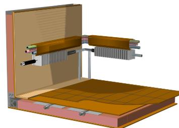
**Système de chauffage intégré.** Le système de chauffage par le sol est raccordé au réseau de convecteurs, permettant à l'air de circuler dans toute la caravane quand le chauffage est enclenché. Le système est alimenté à la fois au gaz et à l'électricité. Les caravanes KABE ont des convecteurs de grande largeur sous toutes les fenêtres.
