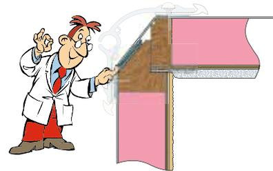
**Joints en caoutchouc butyle.** La pâte au butyle conserve son élasticité pendant toute la durée de vie de la caravane. C'est pourquoi nous avons choisi d'utiliser ce matériau pour tous les raccords de tôle, les recouvrements et les passages de vis. Chaque caravane comporte environ 20 kg de joints en caoutchouc butyle.
