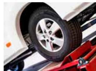
**Essai d'endurance.** L'essai d'endurance est simulé sur un banc d'essai vibrant et correspond à un déplacement normal sur route de 100 000 km.
