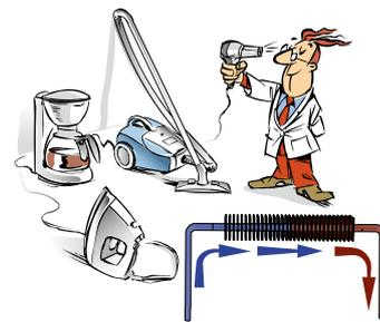
**Moniteur de charge.** La puissance du chauffage baisse automatiquement quand plusieurs appareils gros consommateurs d'électricité fonctionnent simultanément.
