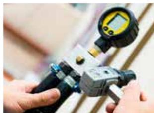
**Gaz.** Le circuit de gaz est testé sous pression.
