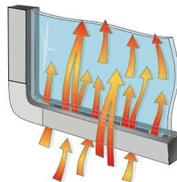
**Fenêtres étanches.** Fenêtres à économies d'énergie avec huisseries en polyuréthane de type K D-Lux, de conception KABE. Pour la meilleure isolation possible, les huisseries de fenêtres en polyuréthane assurent l'étanchéité avec le double vitrage. Avec une ventilation incorporée, l'huisserie de fenêtre est isolée.
