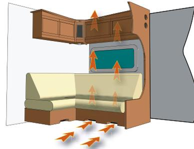
**Banquettes et lits ventilés.** Les banquettes et les lits sont placés sur rehausseurs. Les dossiers des banquettes et les passages de conduites sont inclinés pour accélérer l'écoulement de l'air au passage des fenêtres. Les dossiers des banquettes et la couche d'air prévue sous les lits se réchauffent au passage de l'air chaud le long des cloisons.
