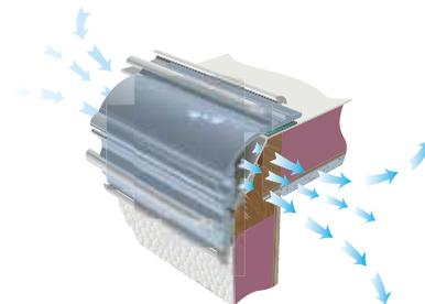
**Profilé aluminium.** Profilé de conception propre, très large, entre le toit et les cloisons. Le profilé intègre une couche d'air prévue pour la ventilation du raccord entre cloison et toit. Le montage du profilé se fait par double ruban d'étanchéité et vissage des deux côtés. Rail intégré sur les deux côtés de la caravane pour montage d'auvent.
