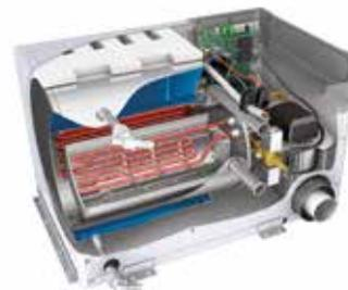
**Chauffage central.** Chaudière ALDE Compact 3020 avec écran tactile et commande électrique de 3 kW. Le système de chauffage comporte une pompe de circulation de 12 V, un chauffe-eau intégré et un vase d'expansion séparé. Production d'eau chaude optimale grâce à l'enceinte de l'unité à gaz. Cheminée de toit pour sécurité de fonctionnement maximale.
