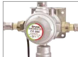
**Duocontrol.** Équipements intégrés : commutateur de gaz automatique, vanne de réduction et capteur de collision se déclenchant en cas de choc avec force G de 3,5 G. L'alimentation en gaz est alors coupée immédiatement pour éviter toute fuite. Le système Duo Control est homologué dans l'Europe entière pour que le circuit de gaz soit enclenché pendant le déplacement.
