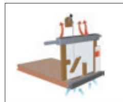
**Optimiertes Lüftungssystem – das patentierte KABE VarioVent.** Dieses patentierte Lüftungssystem ermöglicht im Bedarfsfall die Regelung der Frischluftzufuhr. Die Ventilationsöffnung des Systems lässt sich mit einem Schieber regeln.
