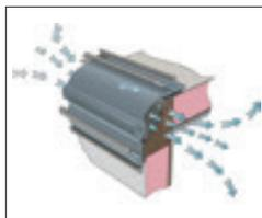
**Aluminiumprofil.** Eigenkonstruiertes, besonders breites Profil in der Fuge zwischen Dach und Wand. Durch ein Luftspalt im Profil wird die Fuge zwischen Dach und Wand belüftet. Das Profil wird mit doppelten Dichtungsbändern montiert und von zwei Seiten verschraubt. Eingebaute Vorzelt-schiene auf beiden Seiten des Wohnwagens.
