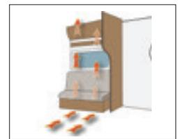
**Belüftete Sofas und Betten.** Sofas und Betten ruhen auf Distanzelementen. Die Rückenlehnen der Sofas und die Kabelkanäle sind gewinkelt, um den Luftstrom entlang den Fenstern zu beschleunigen. Die Rückenlehnen der Sofas und die Kabelkanäle erwärmen sich, wenn warme Luft entlang den Wänden nach oben steigt.
