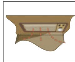
**Komplett ausgerüstete Küche.** In den Küchenschrank integrierter Dunstabzug mit Beleuchtung und zwei Geschwindigkeitsstufen. Der Dunstabzug hat einen Fettfilter, der sich zur einfachen Reinigung abnehmen lässt. Elektrische Herdzündung. Beste Kühlschrank-Entlüftung des Marktes mit Auslass durch das Dach.
