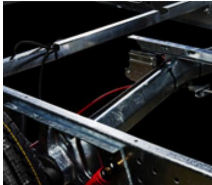
**Besonders verdrehsteifes Fahrwerk.** Zusätzliche Balken zwischen den Längsriegeln des Fahrwerks verstärken den Fußboden und erhöhen die Verdrehsteifigkeit der Chassis. Zwischenbalken für höchste Stabilität. Die Chassis hat Ausleger von den Seitenbalken in Längsrichtung zur Gewichtsentlastung an den Fugen zwischen Fußboden und Wand. Die Karosserie ist für sehr hohe Belastungen ausgelegt, beispielsweise für große Schneelasten auf dem Dach.
