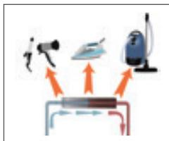
**Belastungswächter.** Die Heizkesselleistung wird bei hoher Belastung automatisch reduziert, wenn z.B. mehrere Elektrogeräte gleichzeitig benutzt werden.
