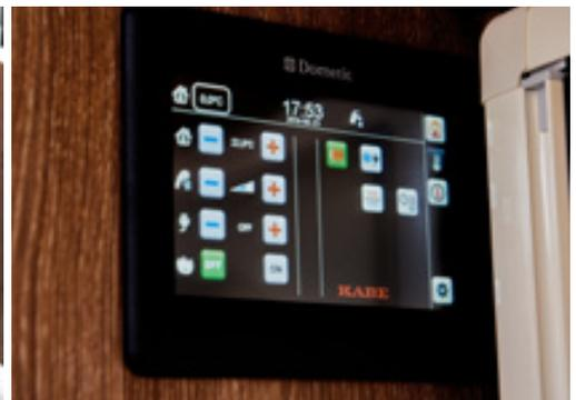
Mit KABE SMART D steuern Sie nicht nur die Heizung und die Beleuchtung, sondern kontrollieren auch den Frischwasserpegel, die Batteriekapazität und vieles andere mehr. All das an ein und demselben Display.
