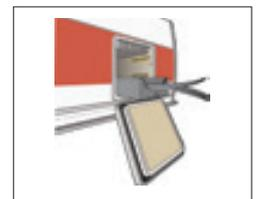
**Skifach und Stauluke.** Ausziehbares, beheiztes Skifach mit Beleuchtung. Eine Diode auf dem Stromschalter im Wohnwagen zeigt an, ob die Beleuchtung ein- oder ausgeschaltet ist. Stauluke unter dem Bett. Die Luke hat eingebaute Luftstromkanäle und die Öffnung ist mit einem selbst entwickelten Konvektor versehen. Das gibt besten Heizkomfort im Schlafabteil. Dank der Stauluke ist der Stauraum unter dem Bett leicht zugänglich (Standard in Royal, Imperial und Hacienda).
