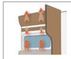
**Freie Luftdurchströmung.** Die Oberschränke haben eingebaute Luftkanäle, damit die Warmluft ungehindert entlang der Verbindung zwischen Dach und Wänden und weiter zur Wagenmitte hin strömen kann. Eine Zwischenwand an der hinteren Schrankkante gewährleistet die ungehinderte Luftzirkulation auch bei gefüllten Schränken.
