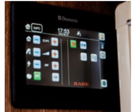
Meldungen und Steuermöglichkeiten für das Heizungssystem werden auf einer eigenen Seite angezeigt. Hier können Sie mit dem digitalen Schieberegler leicht die Temperatur erhöhen oder senken.
