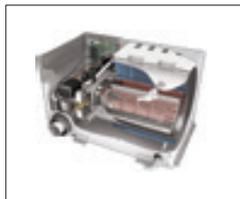
**Zentralheizung.** Heizkessel ALDE Compact 3020 mit Touchscreen-Display und Elektropatrone 3 kW. Das Heizungssystem hat eine Umwälzpumpe für 12V-Betrieb, einen integrierten Boiler und ein separates Ausdehnungsgefäß. Ummantelung der Propangas-Einheit für maximale Warmwasserleistung. Ein Dachschornstein gewährleistet maximale Betriebssicherheit.
