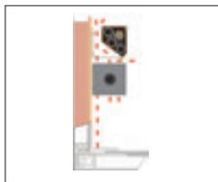
**Gewinkelte Kabelrinne.** Die Wärme der Konvektoren beschleunigt den Luftstrom an den Fenstern vorbei. Unsere einzigartigen Kabelrinnen sind gewinkelt, sodass die Luft ungehindert an den Fenstern vorbeiströmen kann. In der Kabelrinne verlaufen Stromkabel sowie Wasser- und Abwasserschläuche. Im Winter taut eventuell gefrorenes Restwasser in den Schläuchen schnell auf.
