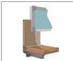
**iWall für eine robuste und feuchtesichere Karosserie.** Die Karosserie wird nach dem Sandwich-Prinzip gebaut: Wandblech, 36 mm Ecoprim-Isolierung, Innenblech und eine Wandtapete, die eventuelles Kondenswasser aufsaugt. Mit der neuen iWall-Konstruktion wird die Karosserie extrem stabil und absolut feuchtesicher. Aluminiumblech auf beiden Seiten der Ecoprim-Isolierung minimiert die Auswirkungen von Temperaturschwankungen.
