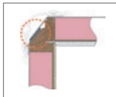
**Butyldichtungen.** Butylbänder behalten über die gesamte Lebensdauer des Wohnwagens ihre Elastizität. Daher haben wir uns für dieses Material entschieden, um sämtliche Blechstöße, Überlappungen und Schraubverbände abzudichten. Pro Wohnwagen werden ca. 20 kg Dichtungsmasse verwendet.
