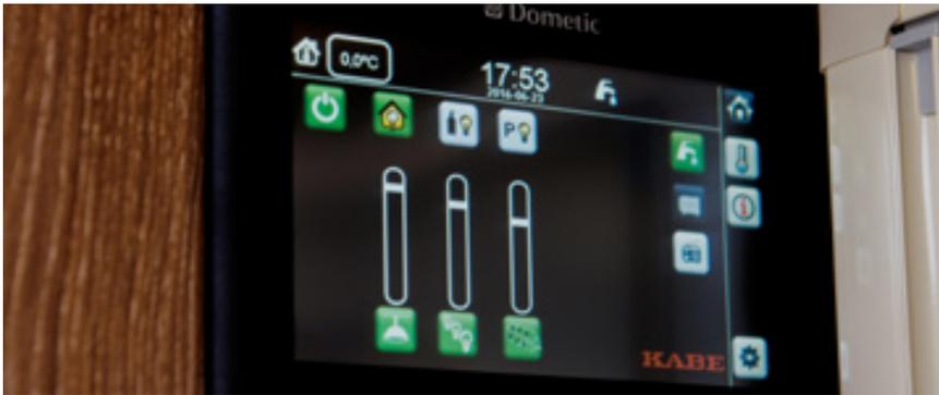
Auf der Startseite werden alle Knöpfe für die Beleuchtung sowie der digitale Schieberegler für die Dimmerfunktion angezeigt. Hier können Sie auch Außen- und Innentemperatur sowie die Uhrzeit angezeigt.
