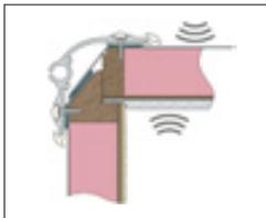
**Weiche, lichtreflektierende und isolierende Decke.** KABE hat als einziger Hersteller eine weiche Innendecke, die für eine bessere Akustik im Wohnwagen sorgt. Die weiche Innendecke hat eine schalldämmende Wirkung und verbessert den Isolierwert der Decke.
