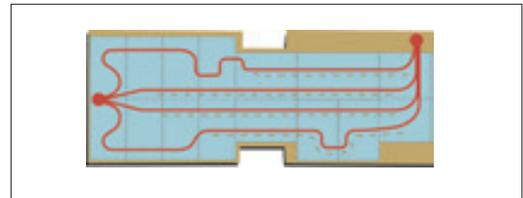
**Beste Heizkomfort.** Die von KABE entwickelte-, automatische Fußbodenheizung AGS II (zum Patent angemeldet) mit vier Heizschlingen sorgt für eine noch gleichmäßigere Beheizung des Wohnwagens. Die Heizschlingen sind in Aluminiumrohren bis direkt an Einstieg, Küchenbank und Toilette verlegt. Heizbleche verteilen die Wärme gleichmäßig über die gesamte Fußbodenfläche.
