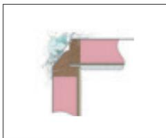
**Dichte Dachfugen.** Die Fugen zwischen Dach und Wänden werden zunächst mit einer elastischen Butylmasse sorgfältig abgedichtet. Danach biegen wir das Dachblech großzügig über das Wandblech, um jegliche Leckage auszuschließen. Die einzigartige iWall-Konstruktion von KABE bietet unzählige Befestigungspunkte, was bei der Montage von Sonderzubehör sehr wichtig ist.
