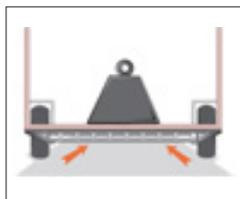
**Zwischenbalken für den Fußboden.** Zusätzliche Balken zwischen den Längsriegeln des Fahrwerks verstärken den Fußboden und erhöhen die Verdrehsteifigkeit des Chassis. Zwischenbalken für optimale Stabilität. Das Chassis hat Ausleger von den Seitenbalken in Längsrichtung zur Gewichtsentlastung an den Fugen zwischen Fußboden und Wand. Die Karosserie ist für sehr hohe Belastungen ausgelegt, beispielsweise für große Schneelasten auf dem Dach.
