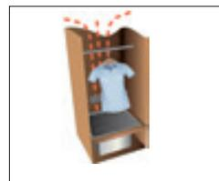
**Trockenschrank.** Trockenschrank mit selbst entworfenen Tropfschale zum Trocknen der Schuhe. Der Trockenschrank hat einen speziellen Konvektor und ein regelbares Dachventil für die optimale Warmluftzirkulation. Beheiztes Schuhfach innerhalb des Einstiegs. Einstiegs Garderobe mit Platz für Oberbekleidung.
