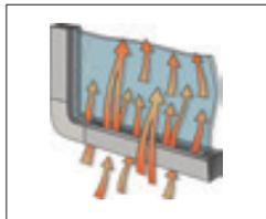
**Dichte Fenster.** Energiefenster mit Rahmen aus Polyurethan – KABEs eigene Konstruktion vom Typ K D-Lux. Die Fensterrahmen aus Polyurethan liegen für bestmögliche Isolierung an den doppelt verglasten Scheiben an. Der Fensterrahmen ist isoliert und durchlüftet.
