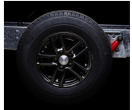
**Reifen und Kupplung.** Die Reifen für Wagen mit Einzelachse sind aus 8 Schichten aufgebaut. Die doppelachsigen Wagen haben 14-Zoll-Niedrigprofilreifen. Alle Wohnwagen haben eine Reibungskupplung
