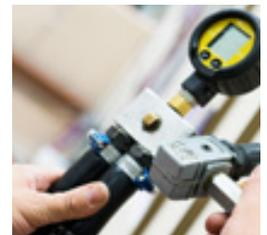
**Gassystem.** Das Gassystem wird Drucktests unterzogen.
