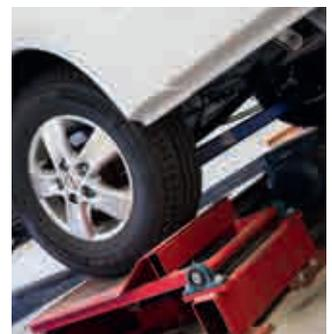
Der Beständigkeitstest wird auf einem Rüttelstand durchgeführt und entspricht einer normalen Fahrleistung von 100.000 km.
