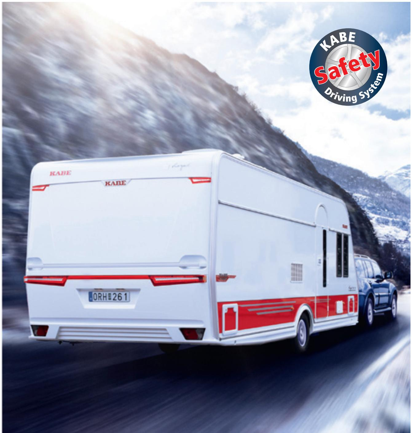
Um noch höhere Sicherheit zu erzielen, hat KABE letztes Jahr das Safety Driving System (SDS) eingeführt. Die Reibungskupplung für mehr Verkehrssicherheit und Fahrkomfort ist bei uns seit langem Standard, wird jetzt aber noch durch längere und stabilisierte Zugbalken und ein elektronisch gesteuertes Anti-Schlingensystem ergänzt. Das System reagiert blitzschnell auf Krängen des Wohnwagens in kritischen Situationen, wie z.B.
