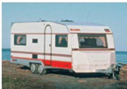
KABE baut Karosserien in Sandwich-Bauweise, wodurch die Wohnwagen leichter werden. Eine völlig neue KABE-Generation wird präsentiert, und 1987 wird die erste Wasser-Fußbodenheizung vorgestellt.
