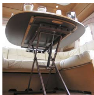
Saksestativ (X0003) Bordet med saksestativ gjør det enklere å felle ned når sittegruppen skal gjøres om til seng.
