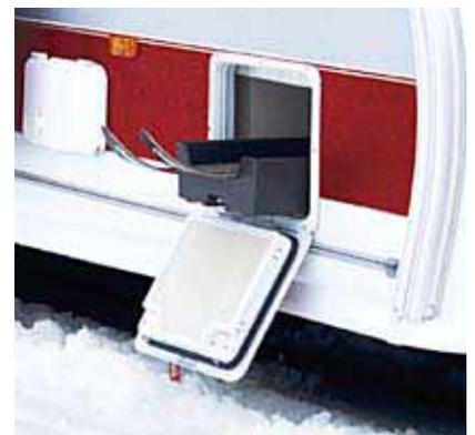
Das Skifach trägt zur optimalen Platznutzung im Wohnwagen bei. Die stabile Box gleitet auf einer Schiene heraus und in ganz ausgezogener Position lässt sich eine Stütze herausklappen. Leicht zu packen, leicht zu finden! Fach ist außerdem beheizt und beleuchtet – eine smarte Lösung, nicht wahr?
