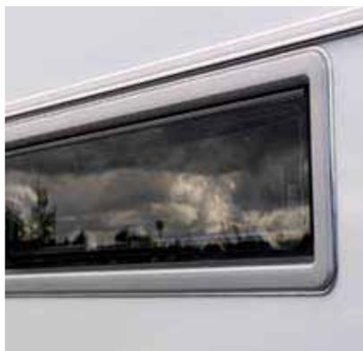
Die Fenster aus KABEs eigener Entwicklung sind etwas ganz Besonderes. Die optimal isolierten Doppelglas-Fenster haben eine flache Außenseite. Die Fensterrahmen bestehen aus Polyurethan.
