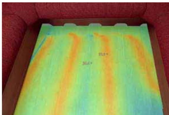
Vier Heizschlingen im Fußboden stellen die gleichmäßige Wärmeverteilung sicher. Wärmeverteilerplatten sorgen außerdem dafür, dass die gesamte Bodenfläche beheizt wird. Die Fußbodenheizung AGS II Pro (serienmäßig in Royal-Wagen) hat eine separate Umlaufpumpe und ein Shuntventil regelt die Bodentemperatur. Dieses zum Patent angemeldete System bietet denselben – wenn nicht höheren – Heizkomfort wie eine Gebäude-Fußbodenheizung.
