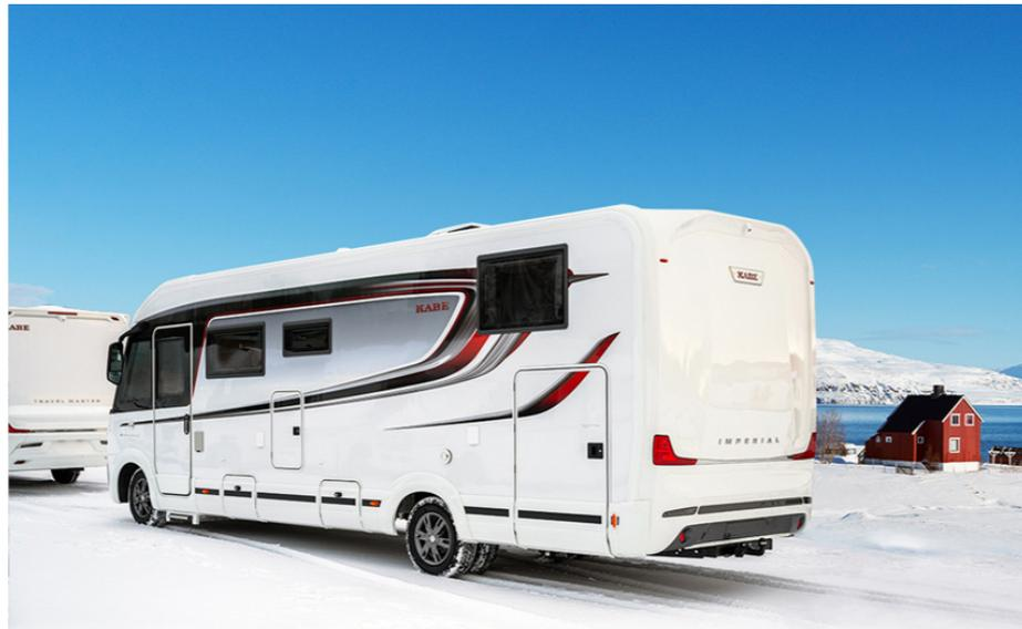
Dank des 190-PS-Motors in Kombination mit den Zwillingsrädern und dem Hinterradantrieb kommt der KABE Ri810 überall hin, auch in schwierigem Terrain.
