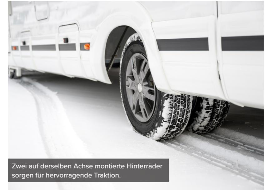
Zwei auf derselben Achse montierte Hinterräder sorgen für hervorragende Traktion.
