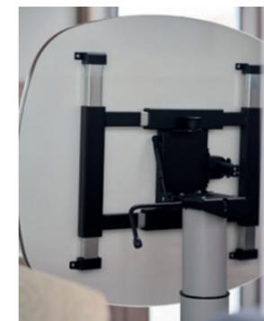
**Klappbare Tischplatte:** Der Tisch ist serienmäßig (außer im Van) klappbar und lässt sich nach vorne kippen, sodass zwischen Fahrersitz und dem Passagierplatz mit Sicherheitsgurt in der Dinette mehr Platz entsteht. Dadurch ist der angeschnallte Passagier bei einer Kollision besser geschützt.
