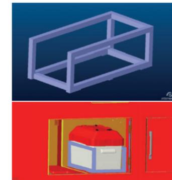
**Stahlrahmen um Batterie:** Ein neuer, stabiler Metallrahmen sichert die Batterie bei einem Zusammenstoß.
