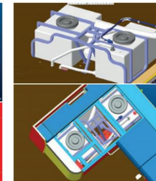
**Stahlrahmen in der Dinette:** Unter dem Gurtplatz der Dinette befindet sich jetzt ein eingebauter Stahlrahmen, der die Sitzplätze bei einer eventuellen Kollision stabilisiert. Der neue Metallrahmen hält außerdem den Wassertank sicher an seinem Platz.
