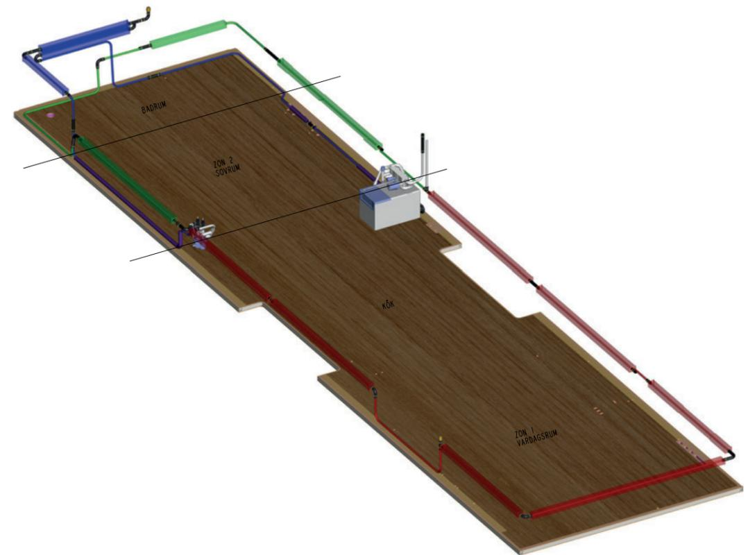
– „Die wasserführende Fußbodenheizung lässt sich mit dem KABE-System AGS II Pro separat steuern. Jetzt wird es außerdem möglich sein, die Heizung in zwei separaten Zonen zu regeln und so unterschiedliche Temperaturen im vorderen und hinteren Teil des Fahrzeugs zu realisieren“, berichtet Manfred Taedcke.
