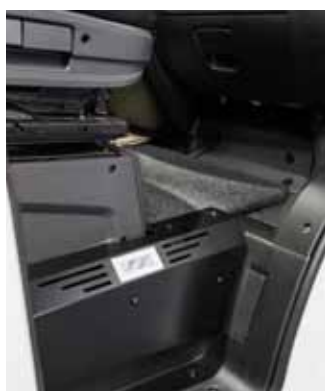
Førerhus med varmekonvektorer ved inngangen - på begge sider.
