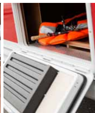
Lasteluke med luftkanaler.
