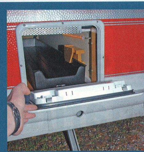
Malliesimerkki hyvästä sähköliitäntäkaapista: virtaa saa ulos sekä verkko- että akkujännitteellä. Televisiolle on liitännät sekä teltan puolelle että keskusantenniin, ja kulutusmittarikin kuuluu vakiovarustukseen.
