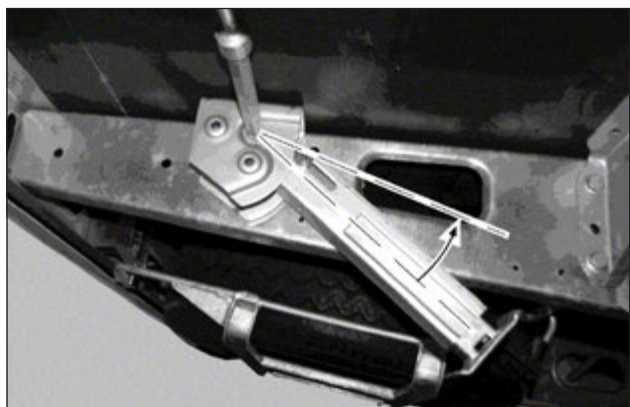
De steunpoot moet omhoog worden gedraaid tot zijn bovenste stand.
