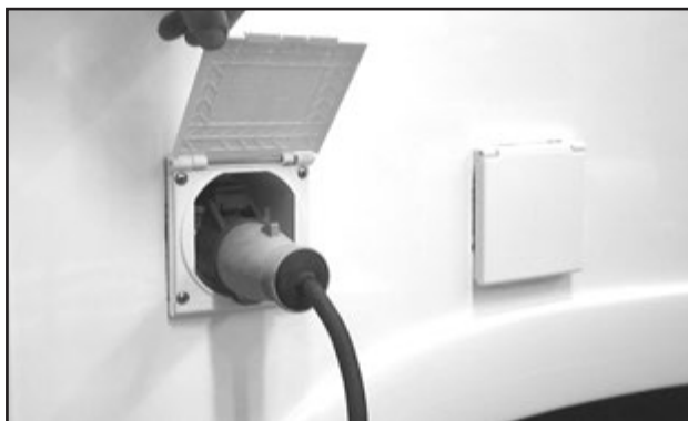
Voor verwarming met het elektrische element is 230V voeding vereist.
