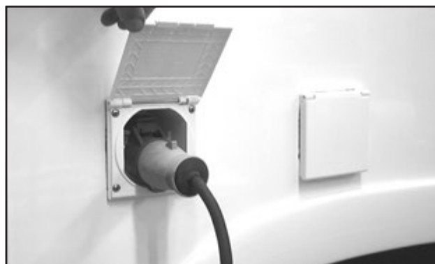
Aansluiting voor 230VAC.
