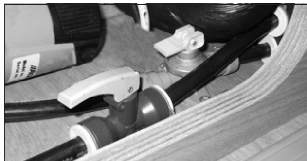
Ablasshähne für Kalt- und Warmwasserschläuche.
