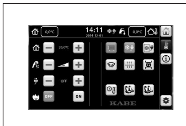
Bedientafel des Wohnmobils, Menü Heizung.
