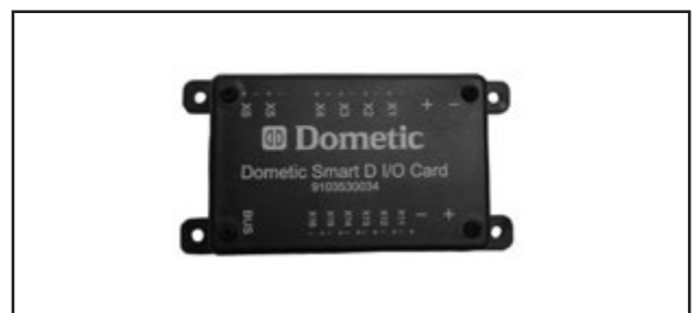
Station des BUS-Systems für 6 elektrische Ein- und Ausgänge.
