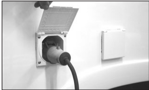
Die Heizpatrone setzt einen 230-V-Anschluss voraus.
