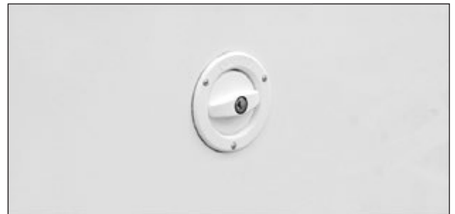
Nachfüllstutzen für Frischwasser.
