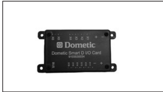
Station des BUS-Systems für sechs elektrische Ein- und Ausgänge.
