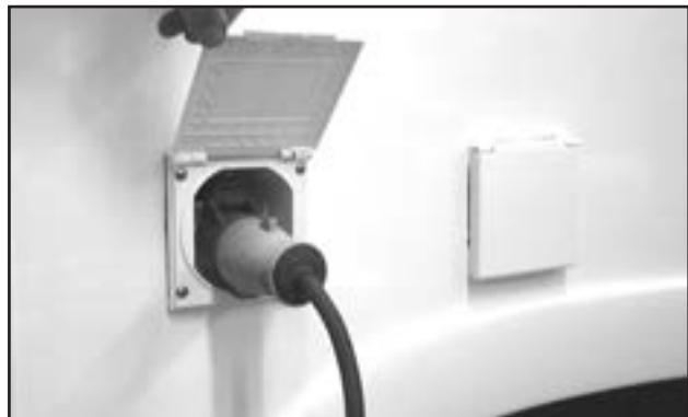
Die Heizpatrone setzt einen 230-V-Anschluss voraus.
