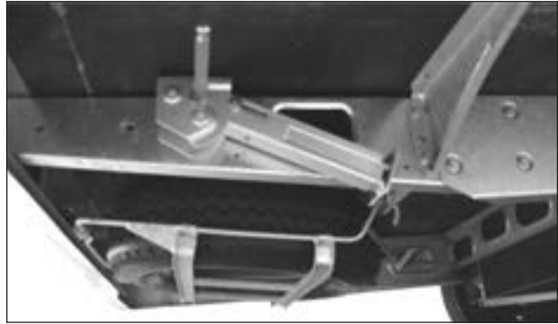
Stützen in oberer Stellung.
