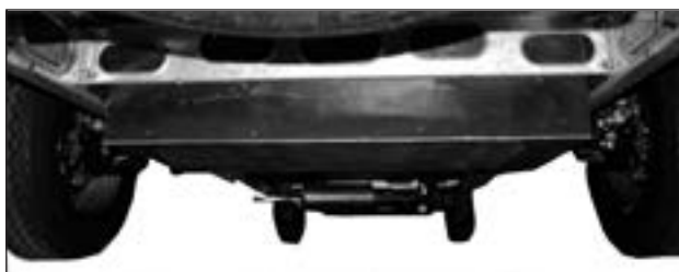
Der Grauwassertank sitzt zwischen den Hinterrädern des Wohnmobils.
