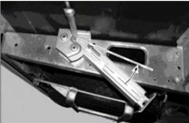
Die Stützen müssen bis zum Anschlag hochgekurbelt werden.
