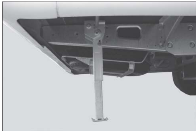
Herabgekurbelte Stütze zu Stabilisierung des Wohnmobils.
