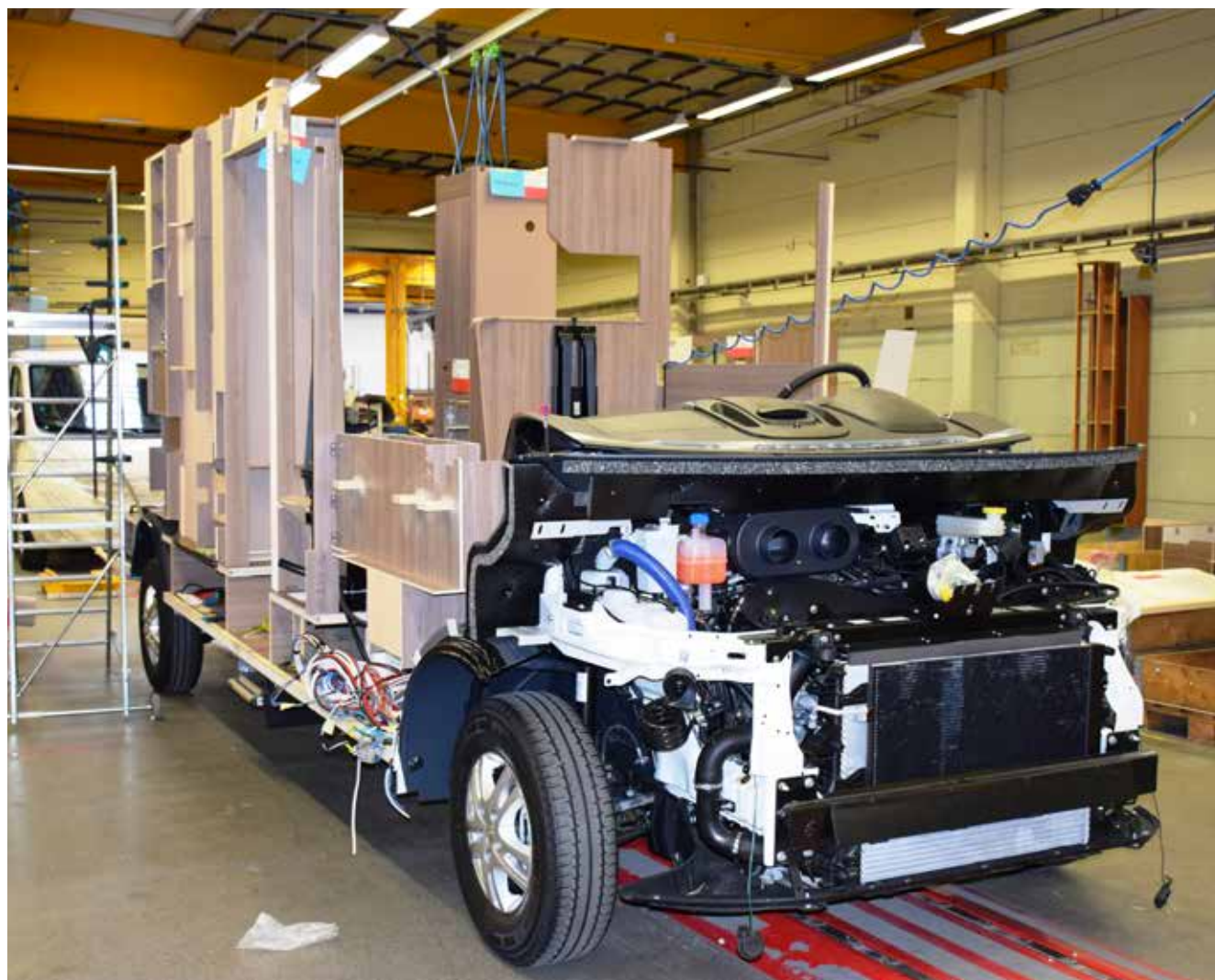
Husbilen på den 160 meter långa motoriserade produktionslinan där den passerar 16 olika arbetsstationer.
