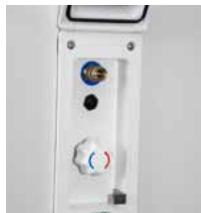
Utvendig dusjuttak Med varmtvann. Vannlås Y0374
