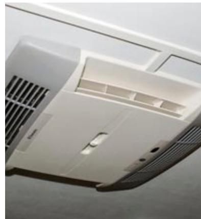
Ilmastointilaitte Dometic Kostuttaa ja pitää asunto-osan ilman miellyttävänä. Asennetaan kattoon.
