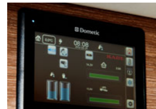
Aktuelle Statusinformationen zu Frisch- und Grauwasserstand sowie die Batterie-Spannung werden übersichtlich angezeigt.
