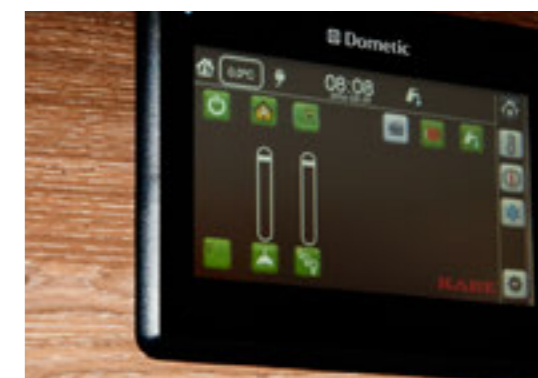
Auf der Startseite werden alle Knöpfe für die Beleuchtung sowie der digitale Schieberegler für die Dimmerfunktion angezeigt. Hier können Sie auch Außen- und Innentemperatur sowie die Uhrzeit ablesen.
