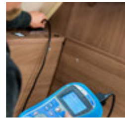
Die elektrische Anlage und andere wichtige Funktionen werden kontrolliert, bevor die Wohnmobile die Fabrik verlassen.
